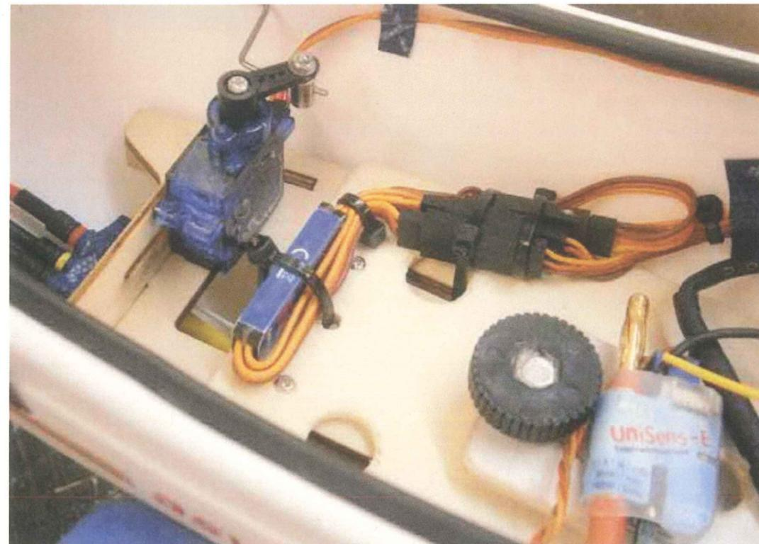
Der iGyro-1e an seinem Arbeitsplatz in einem Segelflugmodell. Hier erfolgt die Stabilisierung des rechten und linken Querruderservos. Dazu muss der Kreisel auf die schmale Seite gekippt werden, sodass die Oberseite nach rechts oder nach links zeigt.
