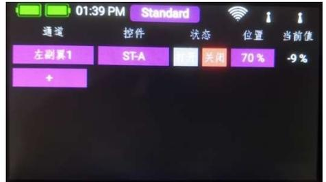
如果指定的遥控器控件设置为关闭，则通道输出将按照先前为该功能定义的方式工作。一旦遥控器控件移到ON位置，舵机就移到预定义的位置；您可以在最右边读取当前值。
