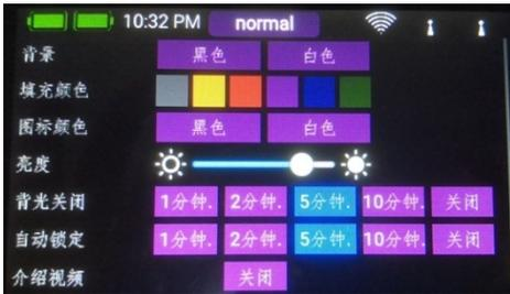
System系统 子菜单用于输入您的姓名、设置时间显示格式、选择首选语言、显示固件版本并在必要时更新固件。另一个重要的地方是遥控器校准菜单 (Calibration)，这将在后面的内容中详细描述。在“屏幕Screen”子菜单中，可以选择背景色和图标颜色。亮度应设置为使您能够清晰地看到屏幕内容的值。
