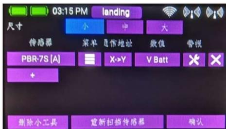
左侧栏显示所有连接的传感器，而右侧栏显示这些传感器提供的所有遥测信息。P<sup>2</sup>BUS是一种内部开发项目，能够传输多达255个传感器，每个传感器有32个单独的值，速度高达每秒800个值！
