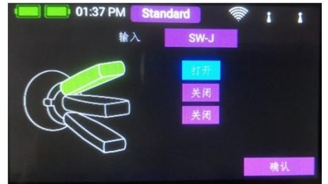
当您设置了多个飞行模式时，您将在飞行模式树状图中看到绿色的破折号，指示当前处于激活状态的飞行模式。在飞行模式下选择单个设置后，现在可以在遥控器控件、微调 and 混控菜单中为不同的飞行模式选择不同的设置。
