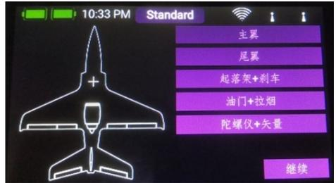
在这里您将看到功能名称（例如左副翼AileronL）、遥控器控件和一个用于分配适当数量的通道的+符号。这些看似单独的选择是相互关联的，用此方法，模型的设置过程将变得轻松愉快。
