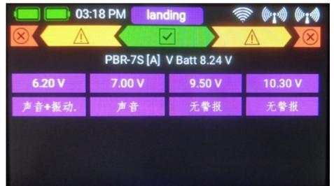
按下后退按钮，返回传感器列表。最后一个按钮（交叉符号）用于从小部件中删除各个遥测值。完成所有设置后，请按底部的“OK确定”。
