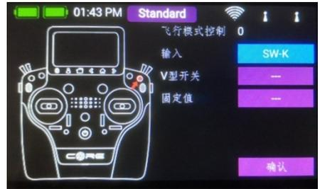
现在，您可以通过操作遥控器来选择要使用的控件；这可以是开关或线性控件。您选择的遥控器控件现在显示在左侧，同时显示一个包含两个开关点的彩条。
