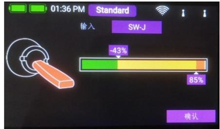
现在，通过用手指移动这两个开关点，可以将它们放置在您需要的任何位置。红色区域表示“关闭状态”；绿色区域表示“打开状态”。橙色区域表示“滞后”，即不发生切换的区域。通过将两个切换点滑块中的一个移动到另一个滑块的前面或后面，可以非常容易地交换“关闭状态”和“打开状态”。
