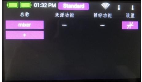
按下右侧的Setup设置按钮，对混控器进行编程。出现以下显示：
