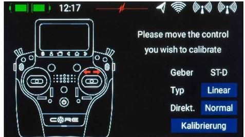
例如，如果要从3档开关更改为2档开关，请在“**Type类型**”中选择适当的开关类型。完成此操作后，触按底部的“**Calibration校准**”，然后将控件移到两个端点，将会出现“**Continue继续**”。如果安装了比例控件或三档开关，还需要将遥控器控件放到到中间。点击“**Finished完成**”以完成该过程。
