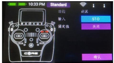
下一步是选择要连接副翼舵机的通道；这是通过按+号来完成的。请注意，一个功能最多可以分配八个通道。如果你的模型是特技飞行飞机，你自然会在这一个功能上选择两个或三个舵机。如果你有多个舵机控制一个舵面，在稍后阶段，您将能够分别设置每个舵机的行程、旋转方向和中立点。如果这些参数太过粗糙，则可以为每个舵机设置最多33个点的单个曲线。（译者注：通过曲线调整，可以让多个舵机运动轨迹一致从而在共同控制的单一舵面上协调工作）回到功能分配屏幕，也可以根据自己的喜好重命名功能。
