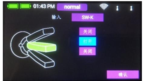
完全相同的程序用于设置附加飞行模式。下图显示了一个用于选择三种飞行模式的开关；FM Normal具有最高优先级。
