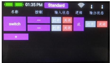
首先在Control下点击空白字段（三个破折号），选择一个遥控器控件；在下一个屏幕上再次按下Control：
