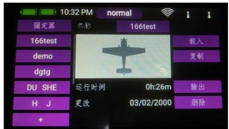
要创建新模型，请短按屏幕底部的+按钮。为您的模型指定一个名字，并用“OK”确认您的选择。现在您将看到模型类型（Modeltype）的选择屏幕。现在，您可以选择适当的模型类型，还可以选择“三角翼Delta”和“V形尾翼V-tail”。
