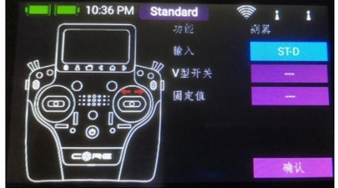
此时，您可以选择需要的遥控器控件。如果您选择一个开关，您可以激活一个或两个开关位置。如果选择线性控制，可以在此处设置开关阈值和死区。请注意，如果您已经设置了虚拟开关，您也可以使用它们来选择飞行模式。
