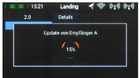
为其中一个绑定的接收机短按“Update更新”。以下屏幕显示当前在遥控器存储器中的软件版本。选择最新版本，并等待更新完成。如果有多个接收机绑定，则对每个接收机重复该过程。
